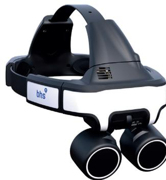
Ein Head-Mounted Display (HMD) erkennt die Kopfbewegungen der Operierenden und verändert die Position des 3D-Kamerasystems von RoboticScope® entsprechend.
