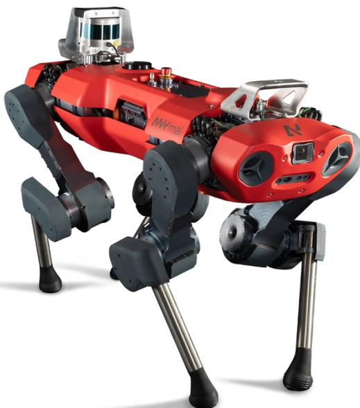
ANYmal C ist ein Inspektionsroboter, der vollautonom durch Anlagen streift und Routinekontrollen durchführt.
