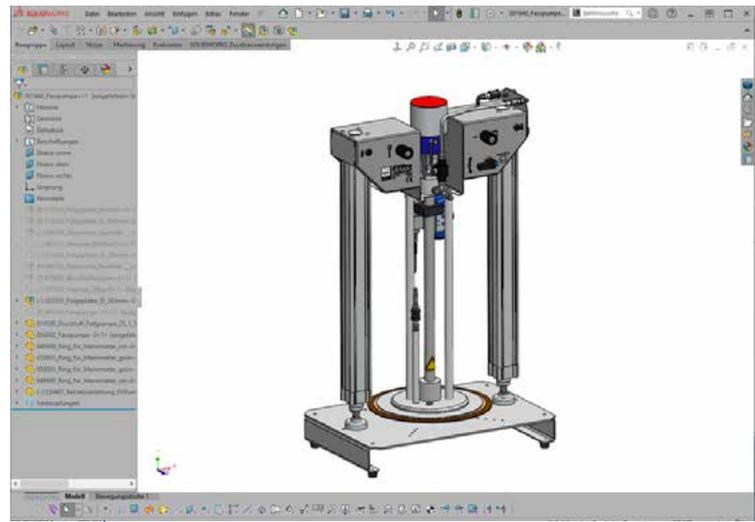
Kompakte, in Fertigungsbereiche einfach integrierbare, Fassungspumpe E4Pump zur prozesssicheren Entleerung von Materialgebinden
