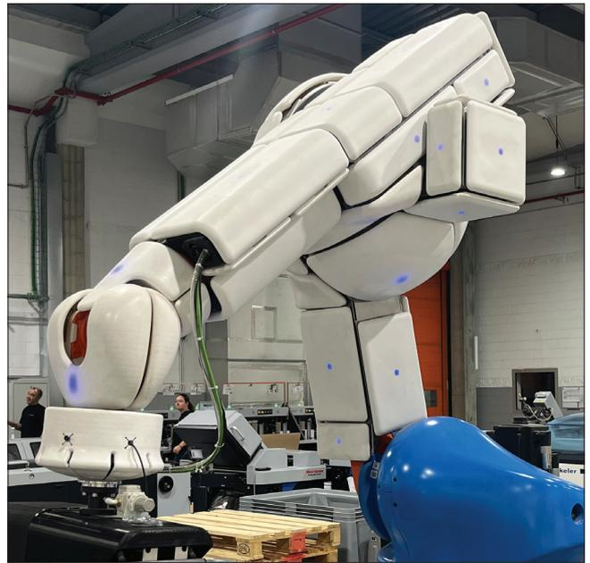
Durch AIRSKIN können Roboter als maschinelle Assistenten direkt neben menschlichen Mitarbeitenden eingesetzt werden, da sie bei kleinsten Berührungen sofort gestoppt werden.
