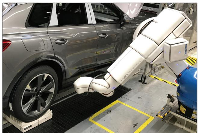
Die druckempfindliche AIRSKIN -Technologie wird in Form von einzelnen Pads magnetisch an verschiedenste Industrieroboter angebracht.
