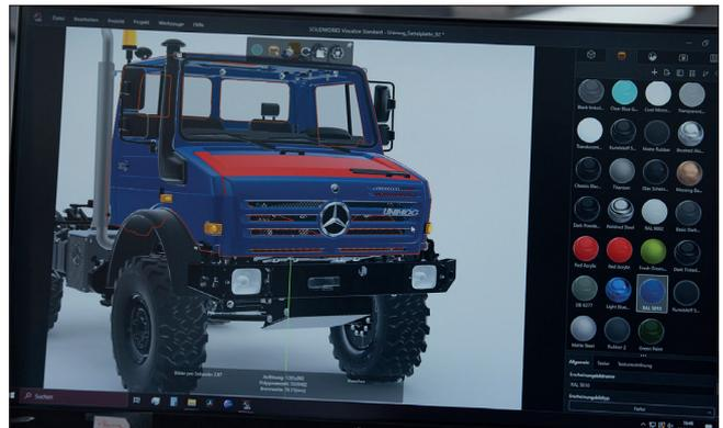
Mit SOLIDWORKS Composer entstehen präzise Montageanleitungen, die jederzeit aktuell bleiben. Für fotorealistische Darstellungen ohne aufwendige Fotoshootings kommt SOLIDWORKS Visualize zum Einsatz.
